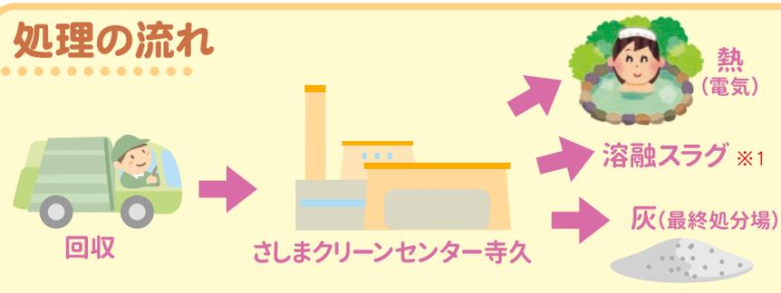
さしまクリーンセンター寺久で焼却します。焼却時に発生した熱を利用して発電や、隣接するさしま健康交流センター「遊楽里」に熱を供給しています。
