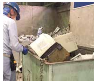
ごみ集積所から運ばれてきたゴミの中から家電製品を回収する方法です。
